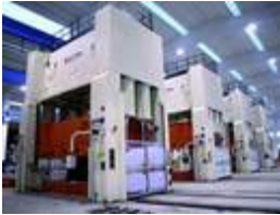
Balconi-Pressen mit Werkzeugwechselsystemen im Werk eines Automobilzulieferers.
