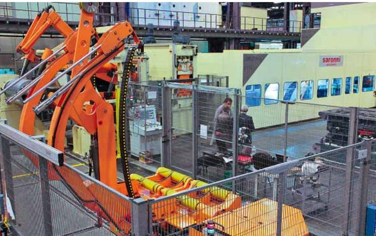
tisch ein Verzurrband zugeführt, um das Coil gelegt und befestigt, sodass das Coil wieder ins Lager eingelagert werden kann. Während dies passiert kann das auf dem zweiten Coilladestuhl vorbereitete Coil bereits in die Anlage eingeführt werden, die Anlage läuft damit fast ohne Unterbrechung weiter.
